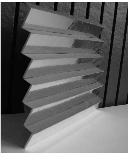
Abb. 6: Ausbildung Verkleidung Lärmschutzwände systemähnlich
